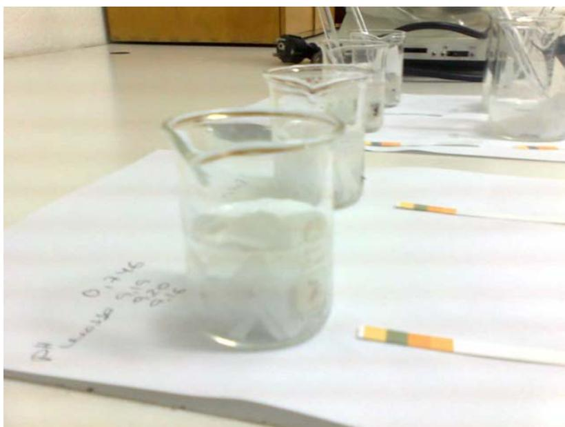
Figura 9: Determinação do  $pH$  da superfície do papel utilizando papel de tornesol.
