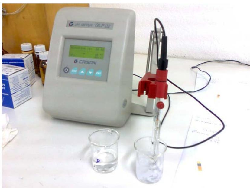
Figura 8: Análises potenciométricas: determinação do  $pH$  da massa do papel.
