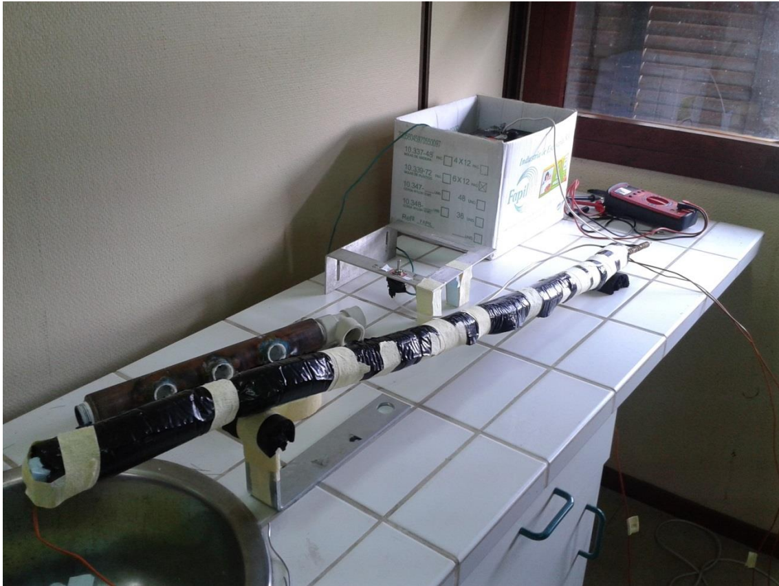
Figura 4.5 – Primeiro modelo de teste do tubo de calor.
