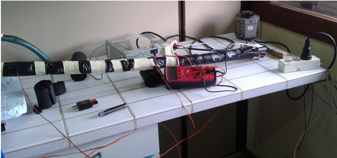
Figura 4.8 – Tubo de calor acoplado e isolado.
