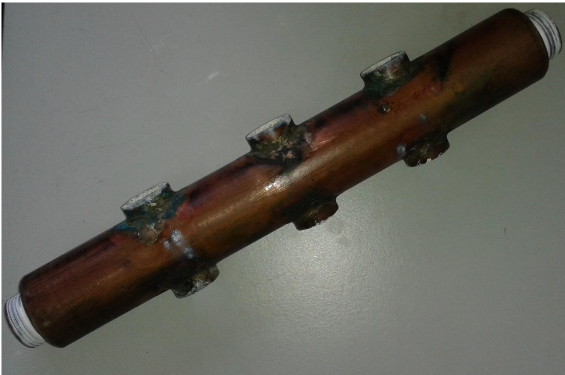
Figura 4.1 – Protótipo estudado com três orifícios de encaixe para tubos de calor.
