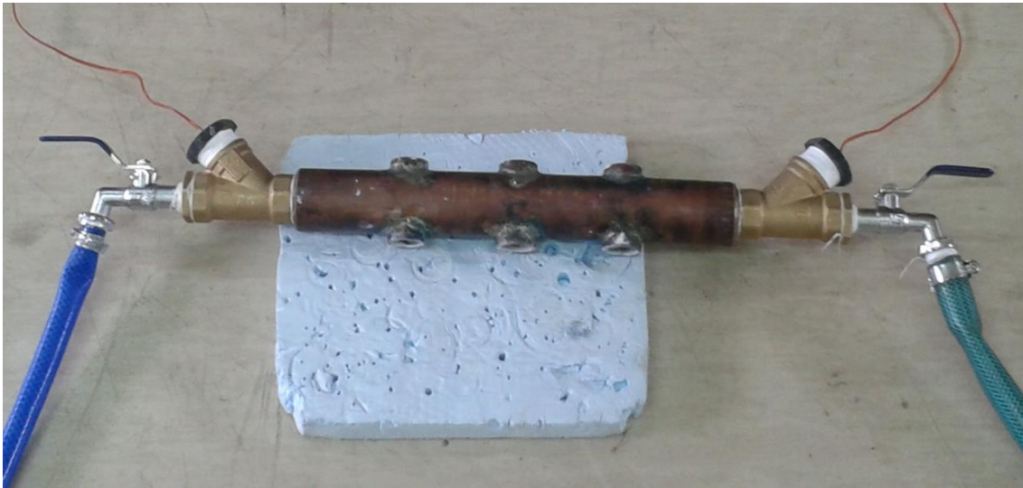
Figura 4.6 – Cabeçote com sensores de temperatura à entrada (azul) e saída (verde)
