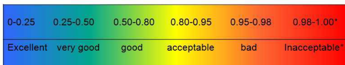
Figura 3.6 – Escala e gama de valores para a Skewness – indicador da qualidade da malha gerada. [7]
