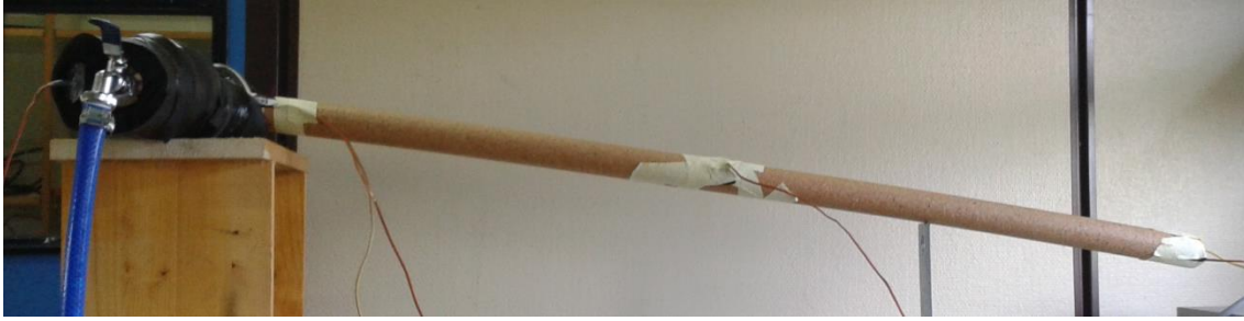
Figura 4.11 – Conjunto cabeçote-tubo de calor com isolamento de cortiça e polietileno de baixa densidade.
