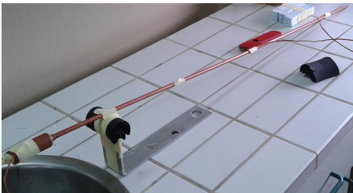
Figura 4.4 – Foto dos sensores colocados no tubo de calor.
