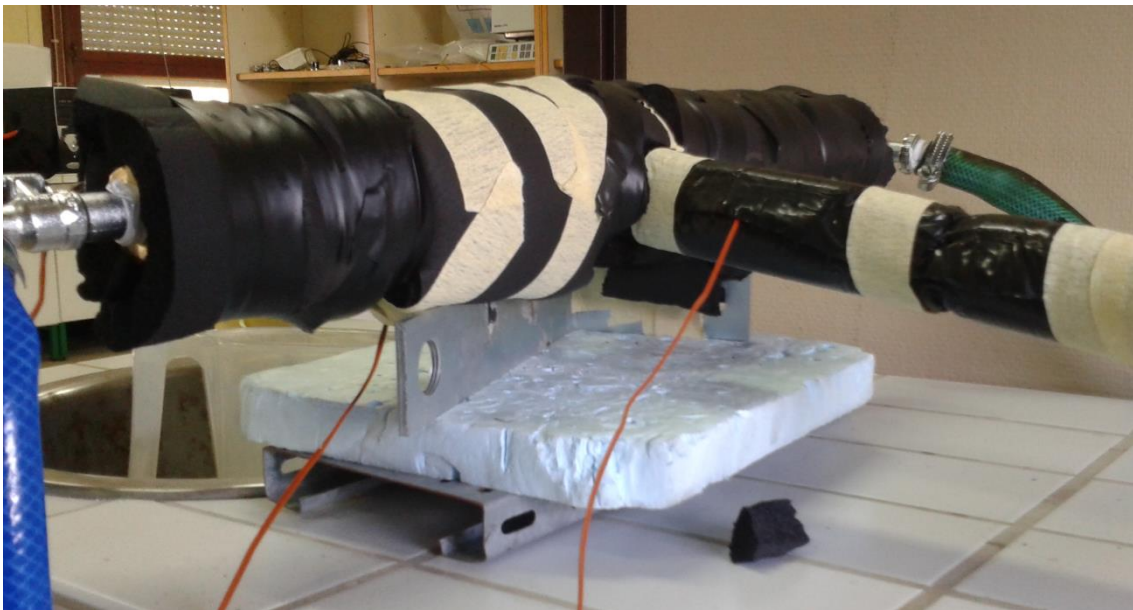
Figura 4.9 – Cabeçote com tubo de calor acoplado e isolado.
