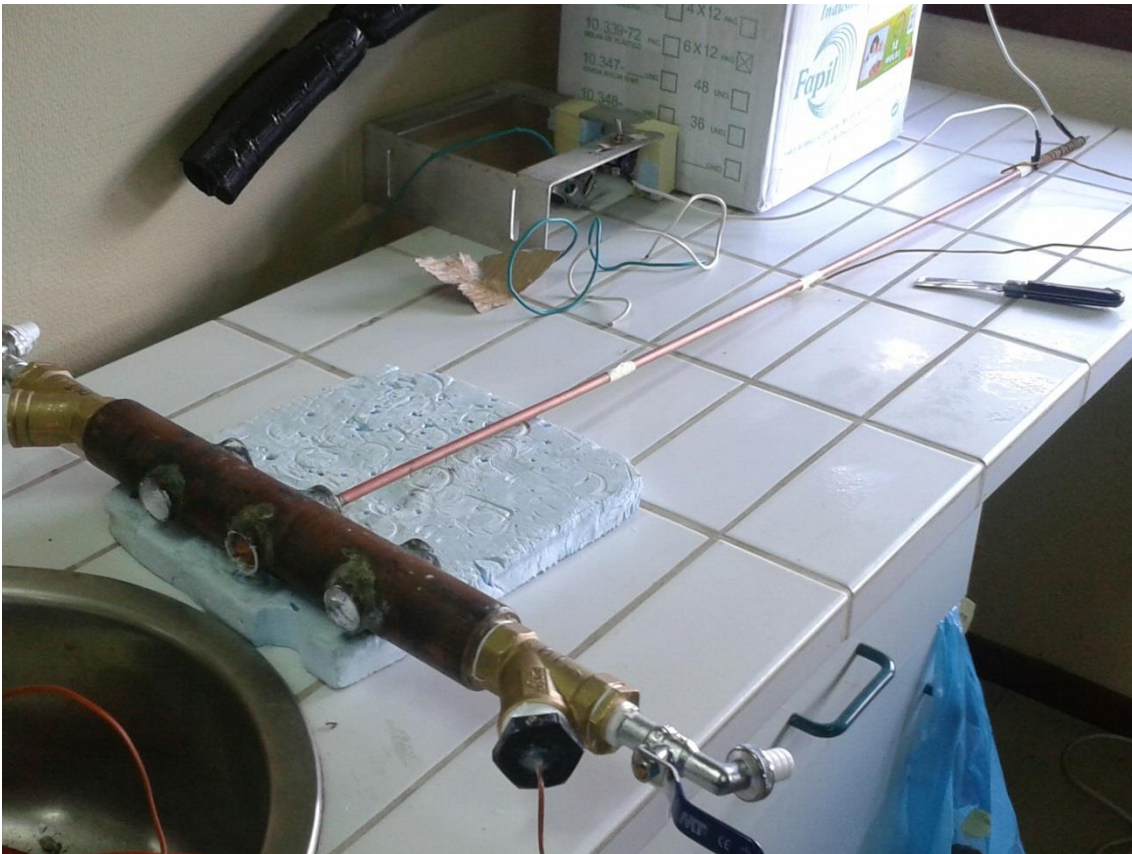
Figura 4.7 – Cabeçote e tubo de calor acoplados sem isolamento.
