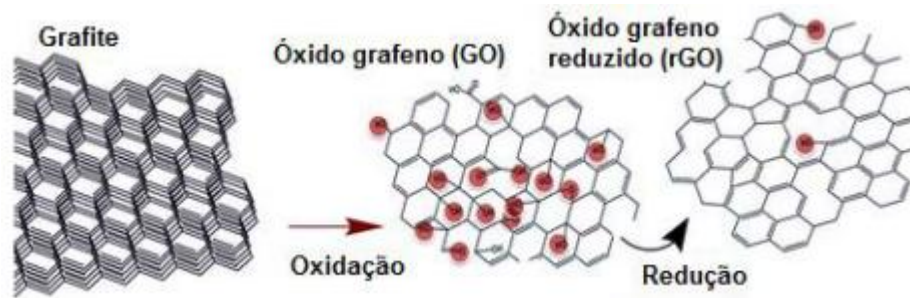
Figura 1.5 – Esquema estrutural do Grafeno e do Óxido de Grafeno (adaptado de [32])
