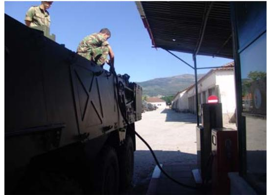
Figura 29 – VBR a atestar o depósito de combustível
