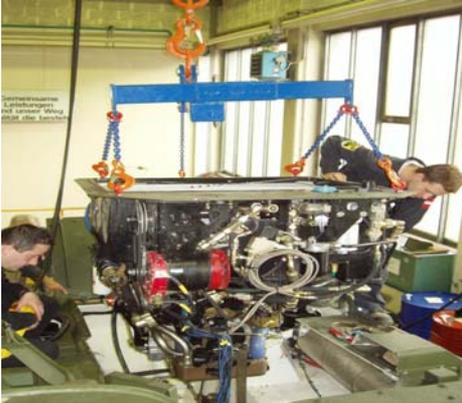
Figura 48 – Pórtico a retirar Power Pack da
