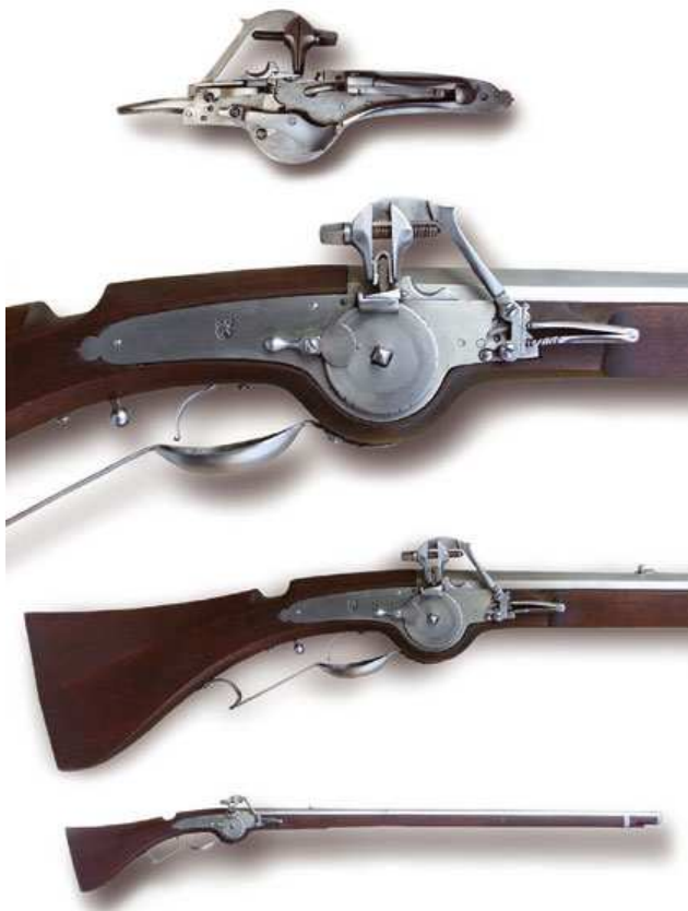
Figura 2: Mosquete com de roda
