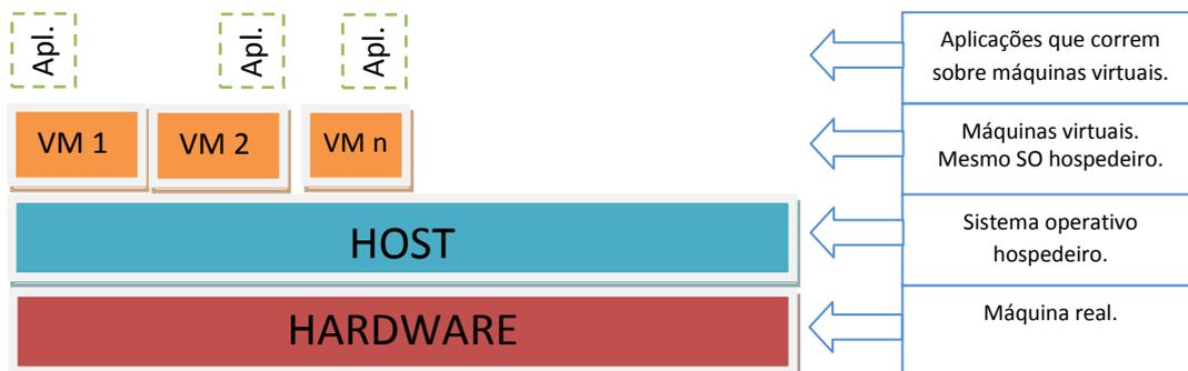
**Figura 11 - Virtualização de servidores ao nível do sistema operativo. Adaptado de LAUREANO (2004)**
