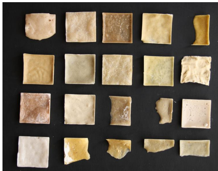
Fig.201 – Exemplos de alguns testes cromáticos das pastas de preenchimento (pigmento natural, alabastro em pó e Paraloid B44®).
