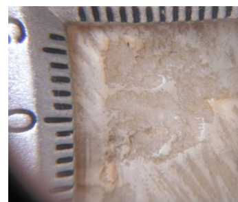
Fig. 96 e 97 – Observação á lupa binocular do suporte, numa zona de fractura e na superfície polida,
