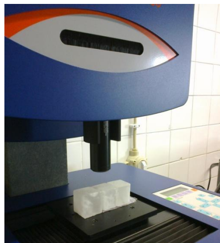
Fig. 72 – Análise a decorrer da superfície dos provetes com o perfilómetro a laser Talysurf CLI 1000, no LNEC.
