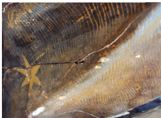
Fig. 145 Camada espessa de goma-laca
