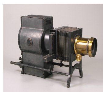
Figura 11: Lanterna mágica da colecção tecnológica da George Eastman House. Imagem cedida por Todd Gustavson
