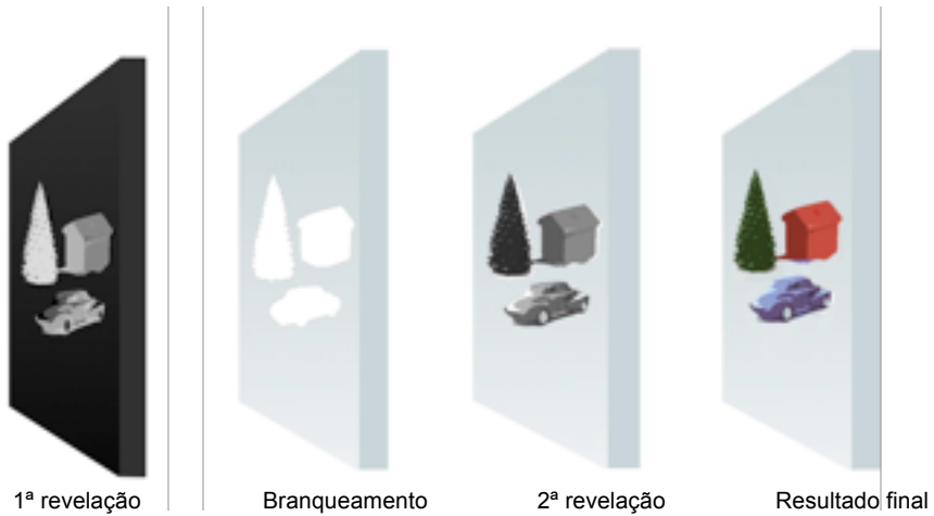
Figura 7: Diagrama da revelação da placa autochrome
