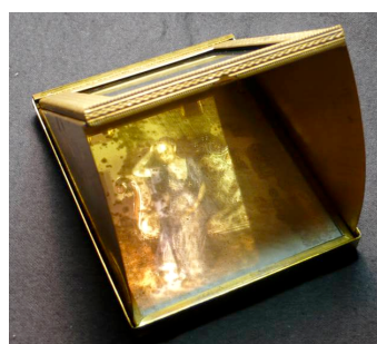
Figura 9: A placa autochrome é colocada de cabeça para baixo no diascope, direccionada para uma fonte de luz, e visualizada no espelho na base do aparelho.
