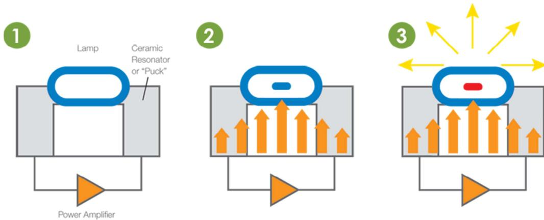
**Figura 4-13 Funcionamento da tecnologia LEP [46]**
