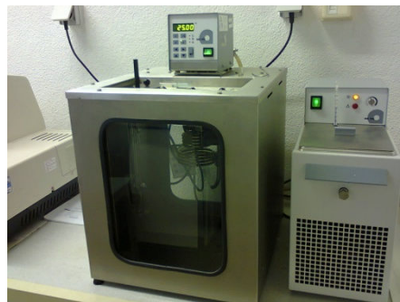
Figura 14 Banho termosestatizado para medir a viscosidade.
