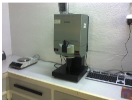
Figura 15 Aparelho de medição do grau de brancura (brancura ISO) (Caima, 2013).
