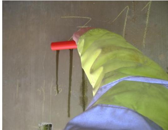
Figura 71 - Sonda de resistividade.
