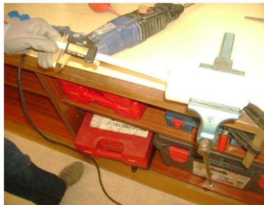
Figura 27 - Verificação da profundidade de perfuração através de um peclise.
