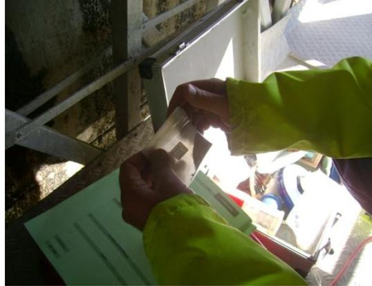
Figura 65 - Amostra para a determinação do teor em cloretos (cl4) do intervalo de profundidade 3 a 4 cm.
