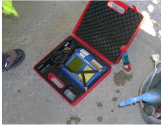
Figura 68 - Equipamento "CANIN" e sonda do mesmo na vertical.
