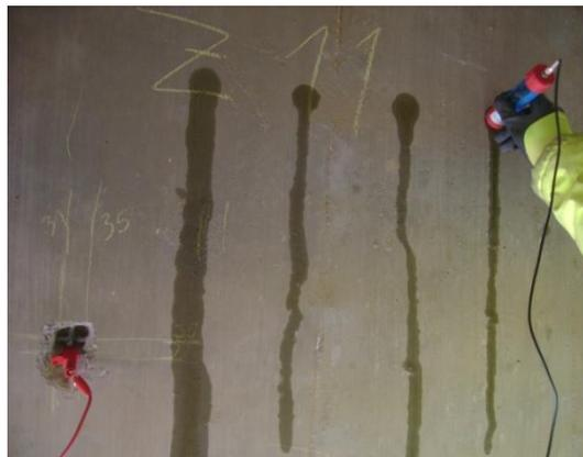
Figura 69 - Medição do potencial elétrico das armaduras (Z.11).
