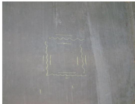
Figura 60 - "Alvo" de onde será extraída a carote (Z.3).
