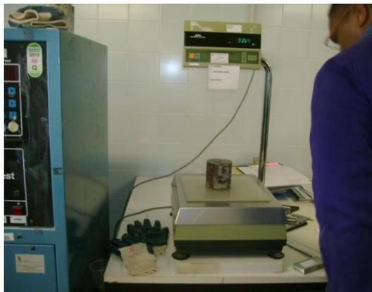
Figura 80 - Balança com precisão de 0,1 g.
