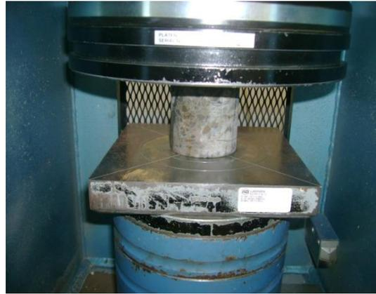
Figura 82 - Carote centrada no prato da máquina de ensaio à compressão.
