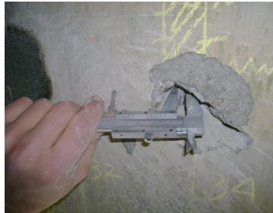
Figura 63 - Medição da secção do varão com um peclise (Z.1).
