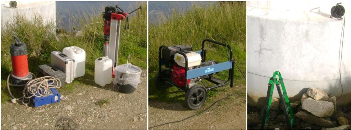
Figura 12 - Equipamentos e meios auxiliares para a extração das carotes.
