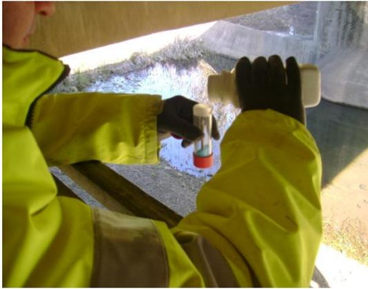
Figura 67 - Introdução do sulfado de cobre no eletrodo da sonda do "CANIN".
