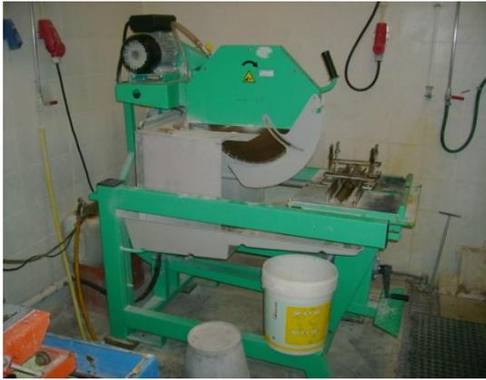
Figura 74 - Equipamento para cortar carotes.
