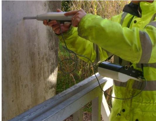
Figura 72 - Esclerómetro Digital.
