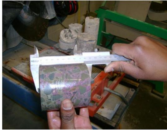
Figura 78 - Peclise para verificar as medidas da carote.
