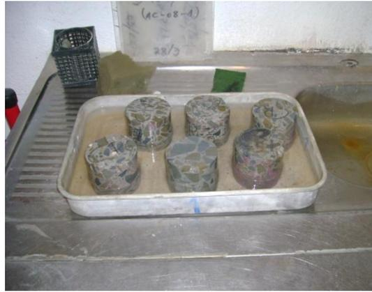
Figura 75 - Carotes dentro de um tabuleiro com água.
