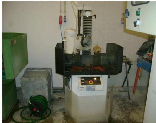
Figura 76 - Equipamento para retificar provetes por desgaste.
