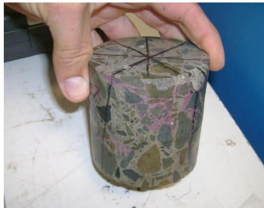
Figura 79 - Divisão das faces de topo e da face lateral da carote.
