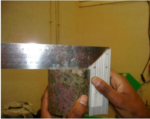
Figura 77 - Esquadro metálico para verificar a planura e a perpendicularidades da carote.
