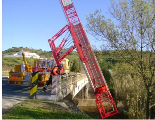
Figura 55 - Lançamento da plataforma amovível.
