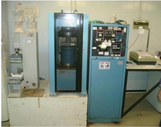
Figura 81 - Máquina de ensaio à compressão de provetes em betão.
