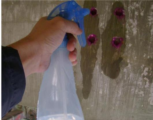
Figura 66 - Pulverização dos furos para a medição da profundidade de carbonatação (Z.5).
