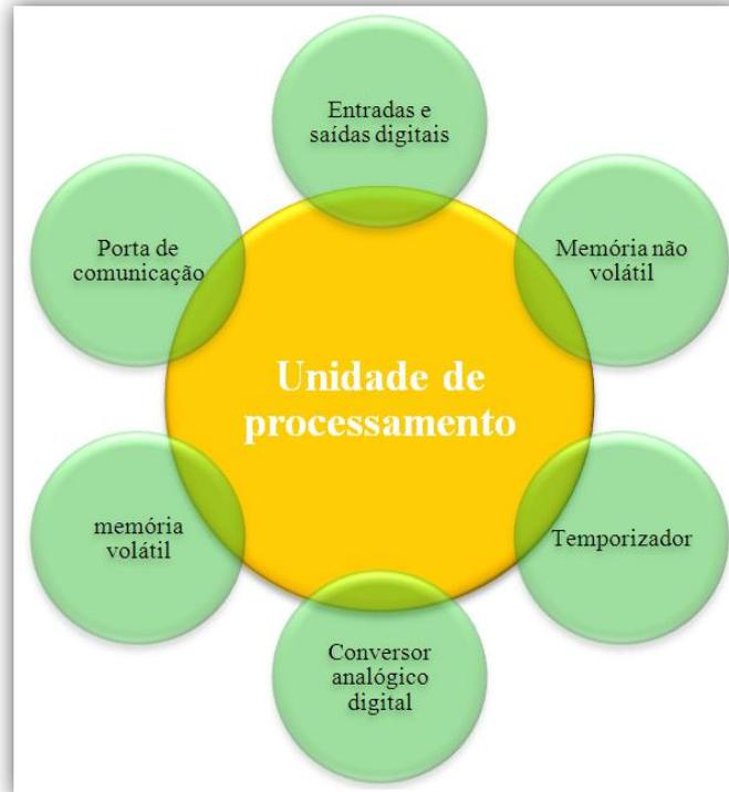
Figura 5.2 – Constituição comum de um microcontrolador.
