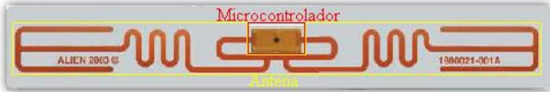
Figura 5.12 – Exemplo de uma tag RFID.
