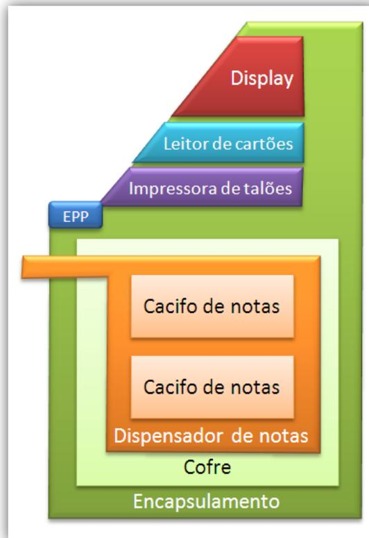
Figura 3.1 – Diagrama de blocos de uma ATM.
