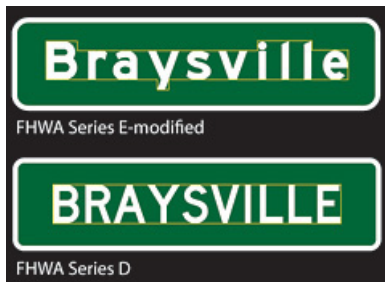
Fig. 113: Incoerência na forma de identificação de uma localidade - tipos de letra FHWA série E-modified e D .
