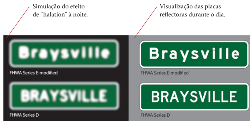
Fig. 114: Processo de visualização das placas reflectoras durante dia e noite - tipos de letra FHWA série E-modified e D .
