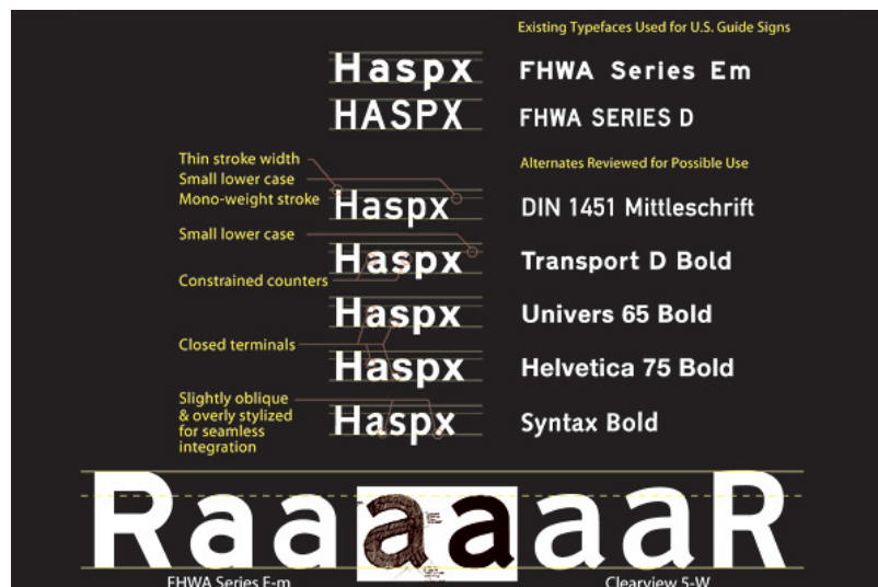
Fig. 115: Análise comparativa de tipos de letra: FHWA series , DIN 1451 , Transport , Univers , Helvetica .
