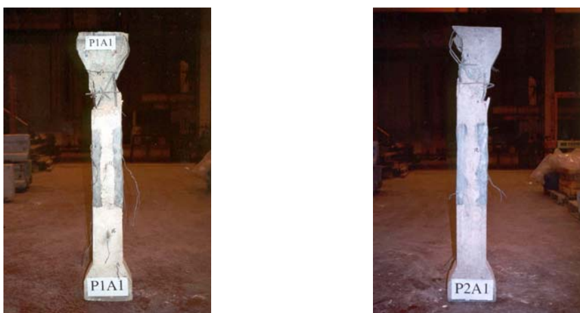
Figura 11 – Ruptura dos pilares P1A1 e P2A1. Argamassa Tipo 1.
