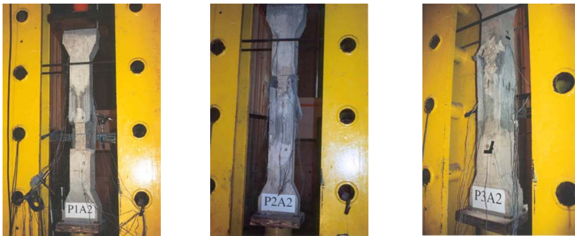
Figura 12 – Ruptura dos pilares P1A2, P2A2 e P3A2. Argamassa Tipo 2.
