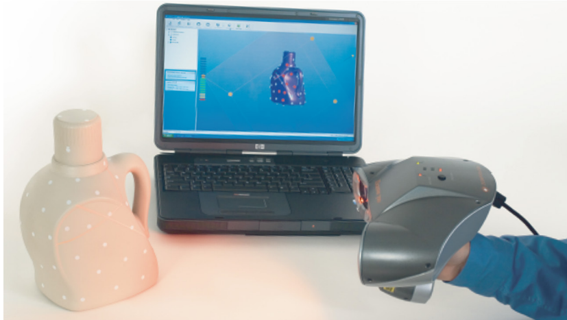
Figura 3.2 Exemplo de um sistema de digitalização portátil [41] (idêntico ao utilizado na cranioplastia in vitro)
