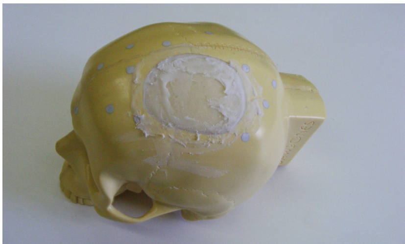
Figura 5.20 Implante colocado sem acabamento
