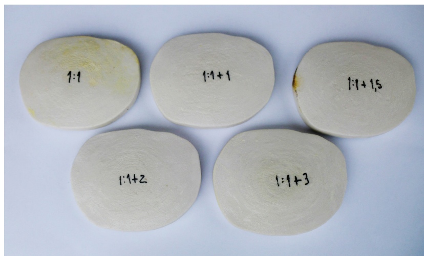
Figura 5.13 Implantes mestre fabricados em pó ZP15E da ZCorp
