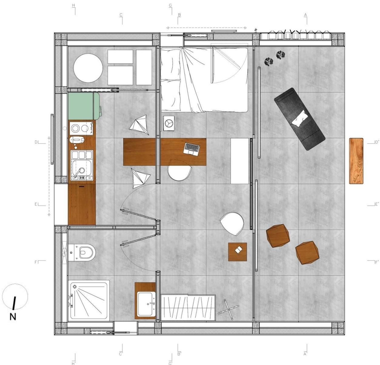
Fig.85> Planta do espaço à escala 1/50 (à escala 1/20 em anexo)
