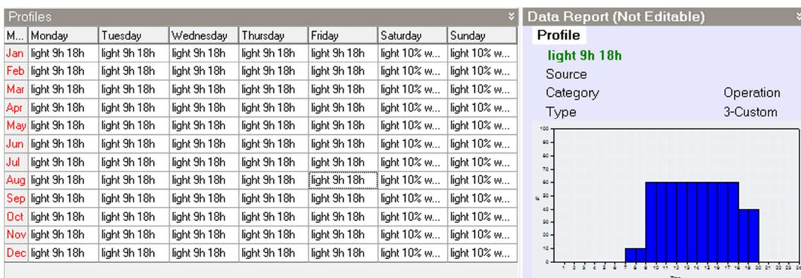
Figura 4.8 – Perfil de iluminação do edifício (DesignBuilder)
