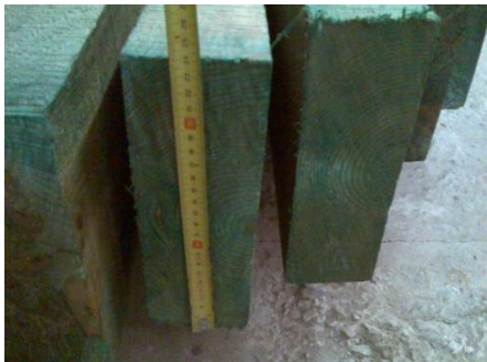
Figura 115 – Todas as vigas aplicadas devem ser conferidas e registadas.
