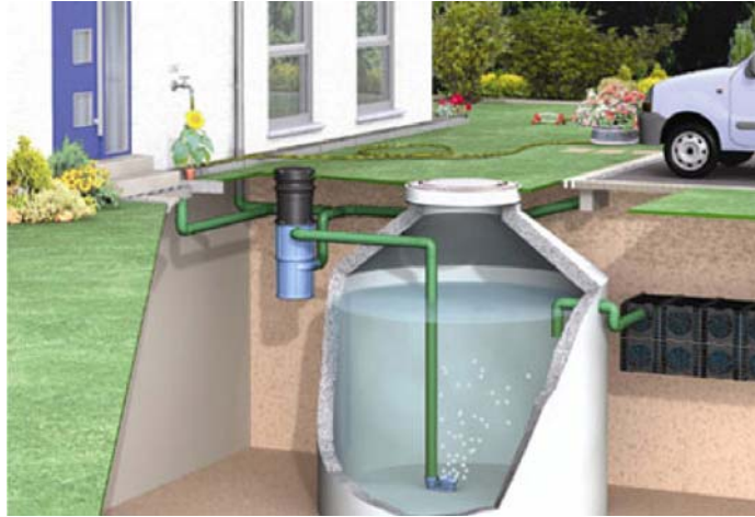
Imagem II.24 – Esquema de reservatório de armazenamento [3.04]
