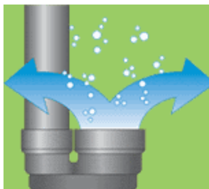
Imagem II.23 – Esquema de tubo de entrada com “amortecedor de água” [3.04]
