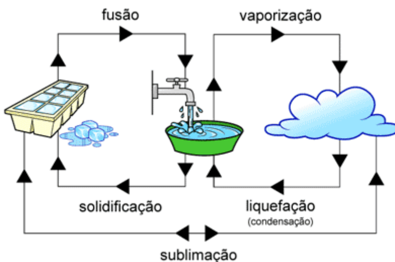
Figura 13 – esquema com estados de agregação da matéria
