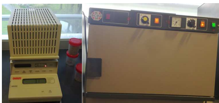
Figura 2: a) Balança aquecida (OHAUS - MB200) e b) Estufa de temperatura controlada para ensaios de Determinação de Teor de Húmida de Biomassas no Laboratório de Química da ESTG, Instituto Politécnico de Portalegre, Portalegre, Portugal.
