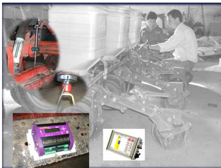
Figura 3 – Sensor de variação linear, célula de carga, data logger e GPS acoplados no semeador
