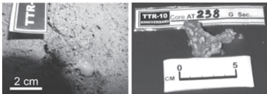
Figura 5 - (a) Dissolução de hidratos observada num *core* obtido no vulcão de lama Captain Arutyunov (TTR-12), aquando da sua abertura. (b) Hidratos de metano recuperados do vulcão de lama Ginsburg (localização na figura 1) durante o cruzeiro TTR-10, em 1999.
