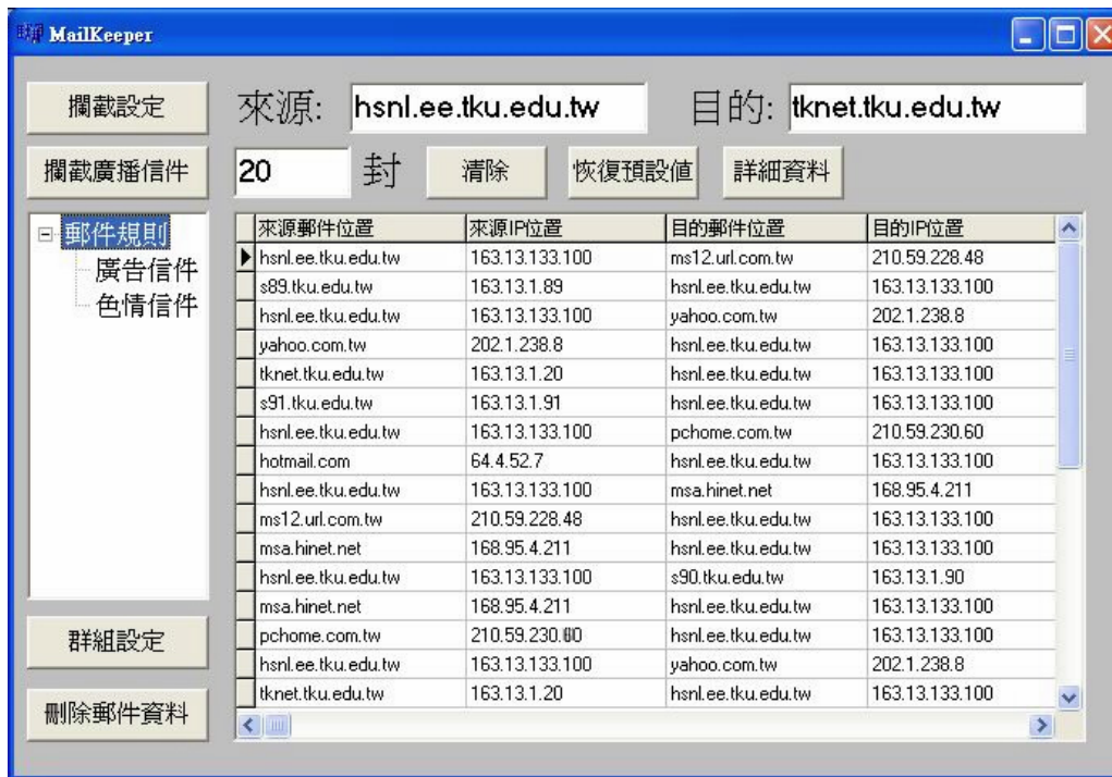
圖三、設定或修改對電子郵件封包所進行的篩選與控管策略。
