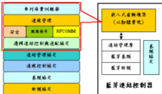
圖 9：藍芽裝置端軟體結構示意圖
