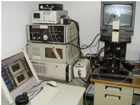
圖 3-3-9 AVID 光學干涉儀量測設備
