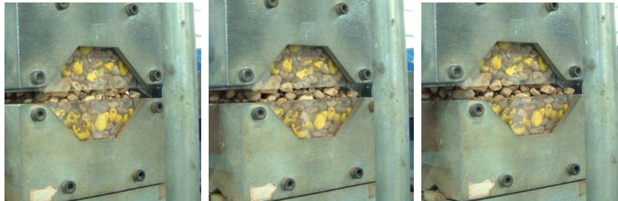
圖 7.5 添加紅土為填充材試體(PR 組)之剪動過程骨材運動觀察
