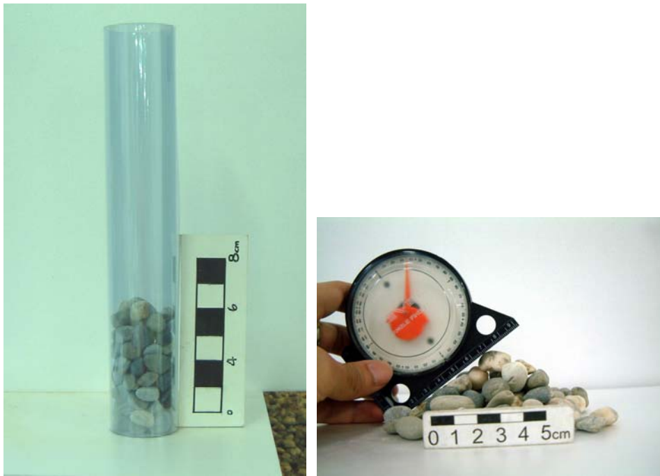
圖 6.4 以圓柱筒抽坍骨材之試驗與安息角量測
