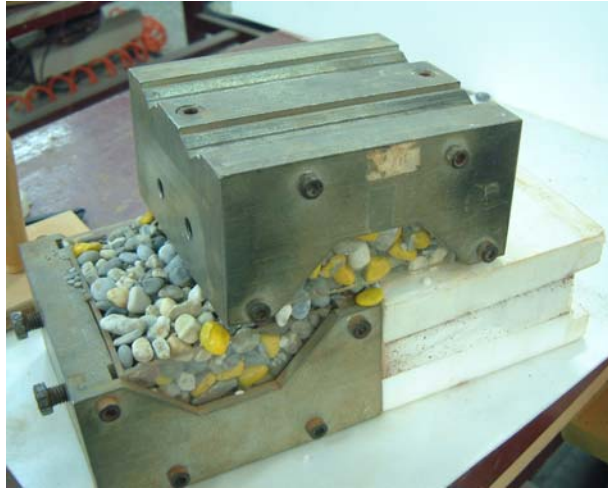
(a) FE 組試體剪裂後將直剪上下盒推開
