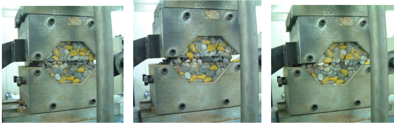
圖 7.4 純骨材試體 (FE 組) 之剪動過程骨材運動觀察
