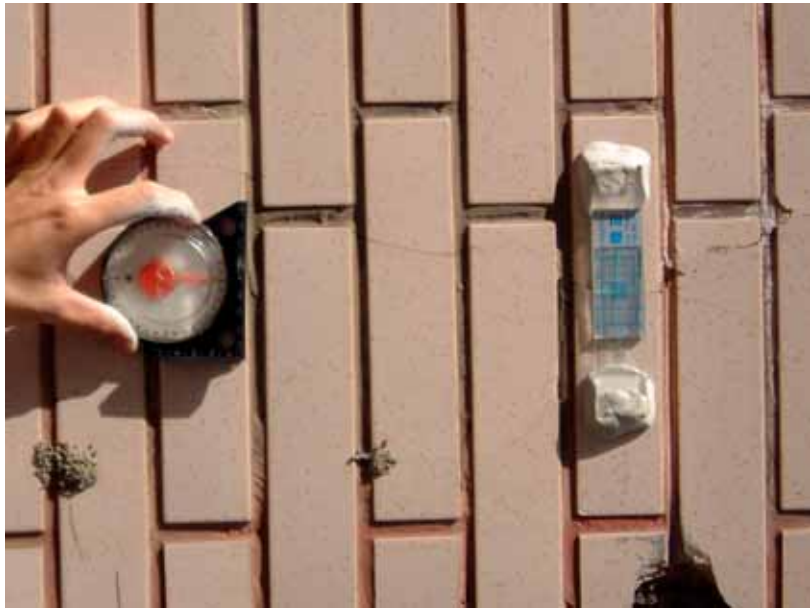
圖 20 即時裂縫點和傾斜點位佈置施作圖
