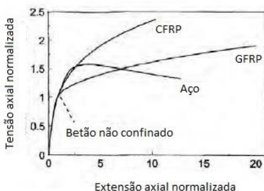
Figura 22 - Comparação entre os diagramas tensão-extensão axial do betão não confinado e confinado com aço e com FRP (Adaptado de Spoelstra & Monti, 1999)
