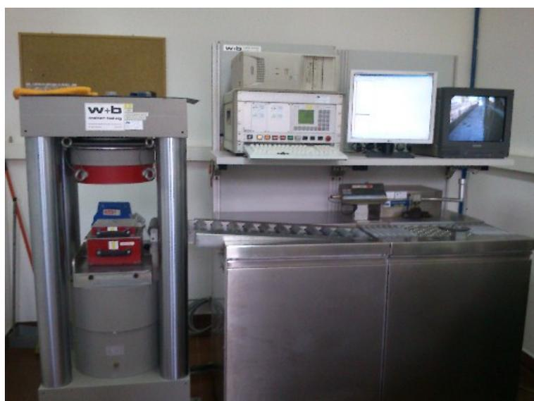
Figura 4-36 – Máquina de ensaios à compressão para os betões
