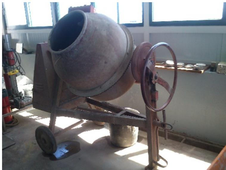
Figura 4-35 – Betoneira utilizada na amassadura de betões
