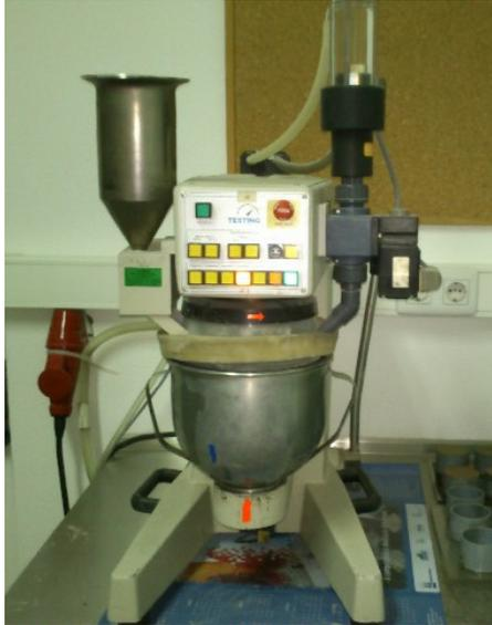
Figura 4-11 – Misturador mecânico utilizado nas amassaduras das pastas
