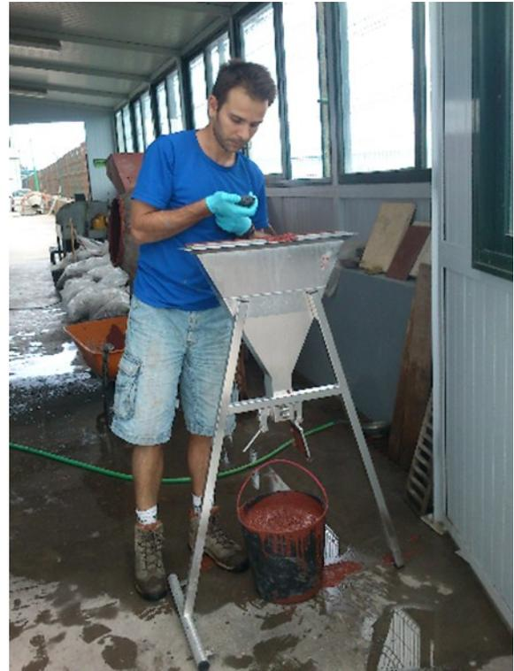
Figura 4-42 – Medição do  $t_v$  de um BAC no funil V
