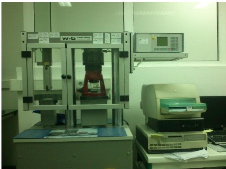
Figura 4-22 – Equipamento de ensaio das resistências mecânicas nas argamassas
