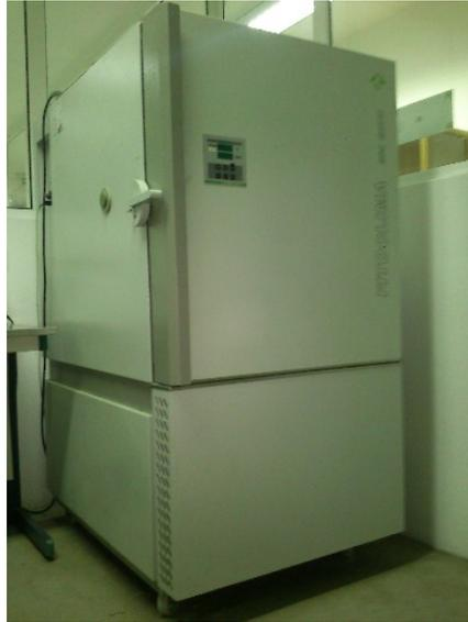
Figura 4-23 – Câmara climática utilizada no armazenamento dos moldes de argamassa
