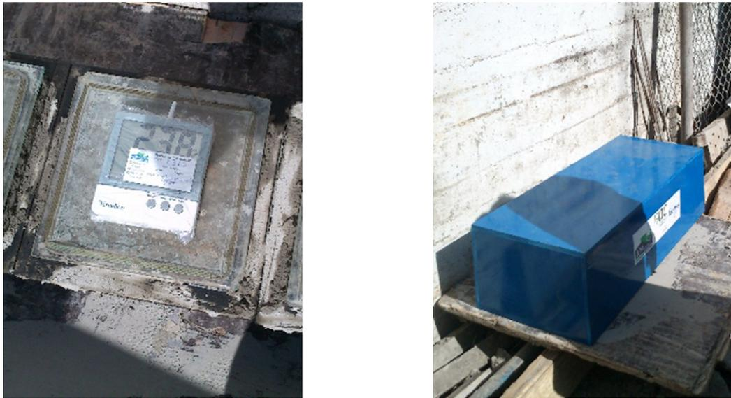
Figura 4-46 – Colocação de proteções à desidratação e variações térmicas dos provetes de BAC
