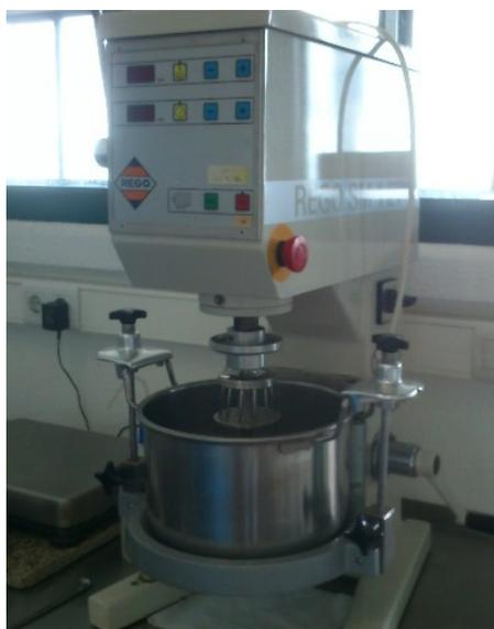
Figura 4-21 – Misturador mecânico utilizado na amassadura de argamassas
