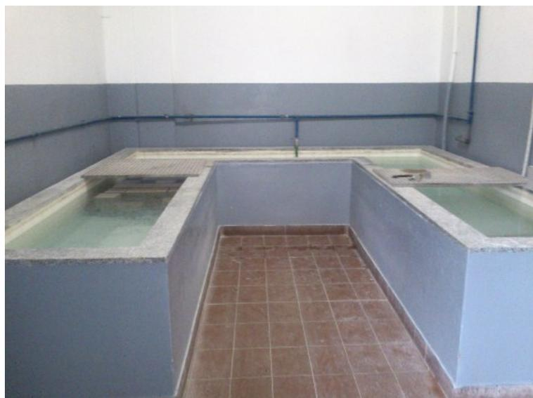
Figura 4-48 – Câmara de cura dos provetes de betão
