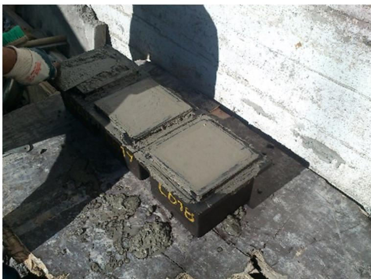
Figura 4-45 – Regularização de provetes de betão nos moldes
