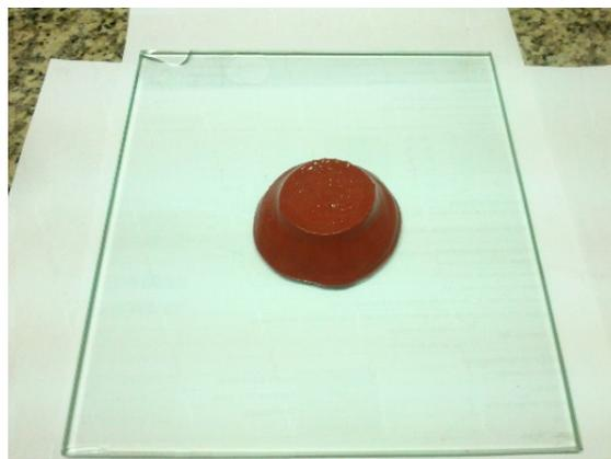
Figura 4-16 – Pasta com CEM II/B-L 32,5R (br) e com adição de 10% em volume de pigmento vermelho
