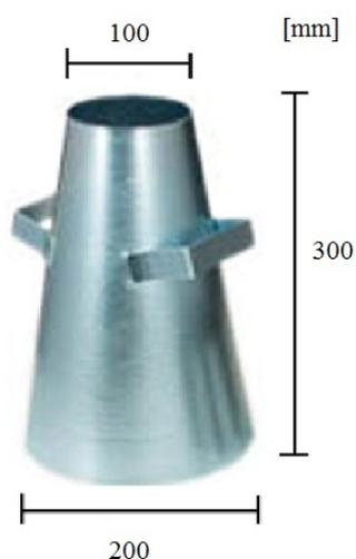
Figura 4-31 – Dimensões do cone de espalhamento [68]
