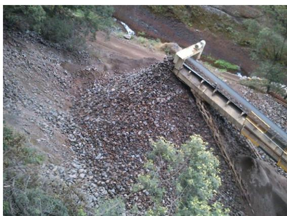
Figura 4-5 – Transporte dos agregados britados em correias de transporte
