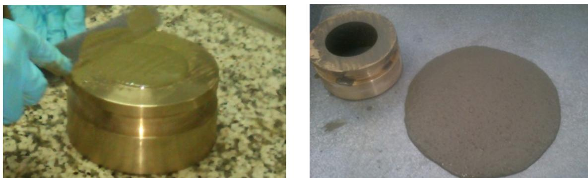
Figura 4-26 – Ensaio de espalhamento para uma argamassa
