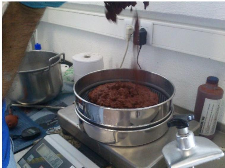
Figura 4-44 – Ensaio de resistência à segregação
