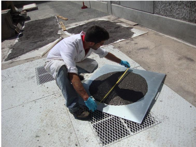
Figura 4-40 – Medição do diâmetro de espalhamento de um BAC
