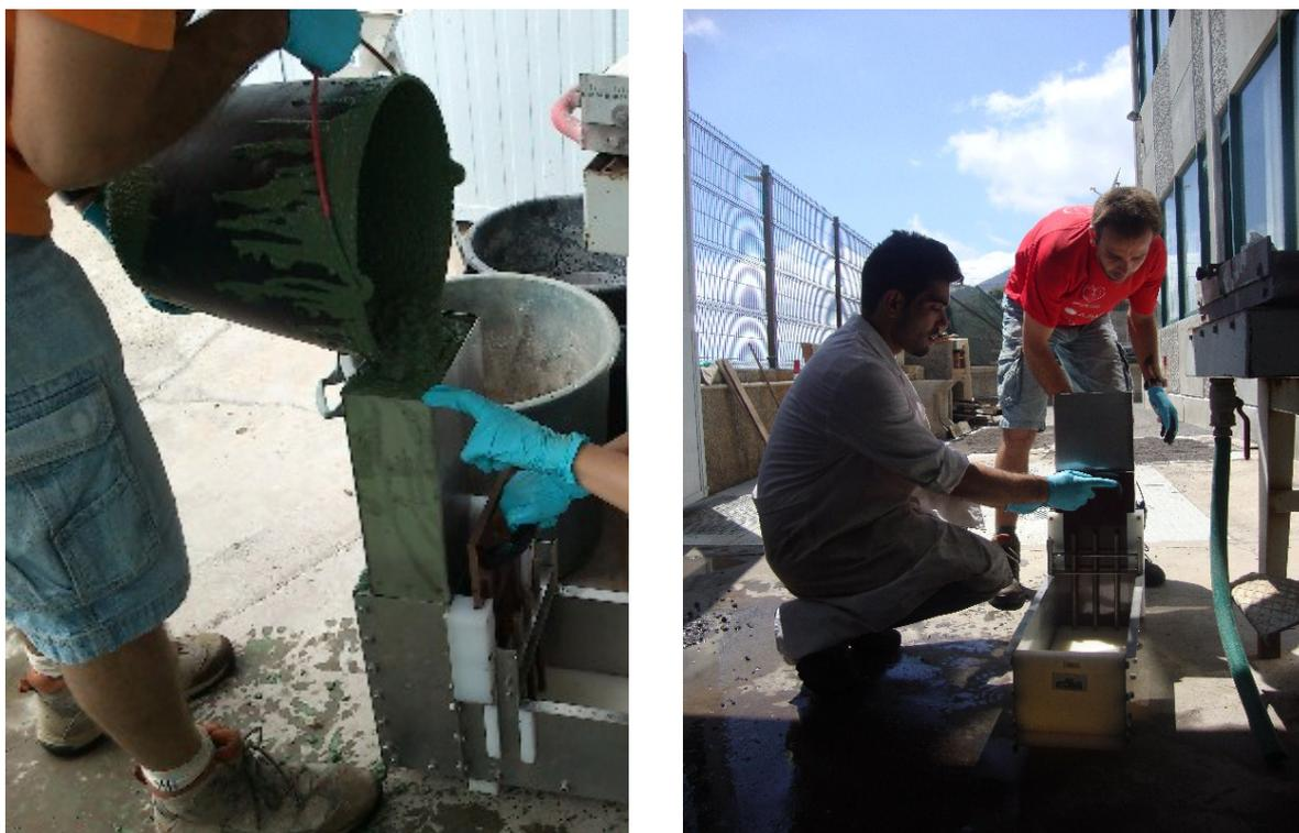
Figura 4-43 – Ensaio da caixa L
