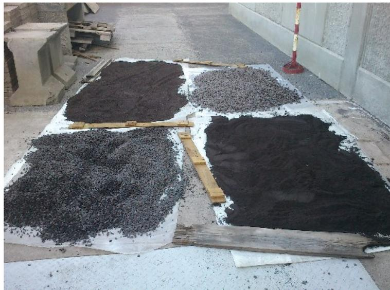
Figura 4-8 – Início do processo de secagem dos agregados
