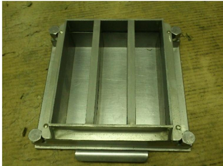
Figura 4-24 – Moldes para armazenamento das argamassas
