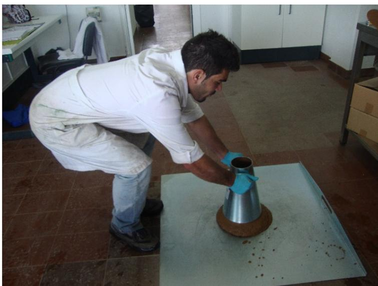
Figura 4-39 – Levantamento do cone no ensaio de espalhamento do BAC
