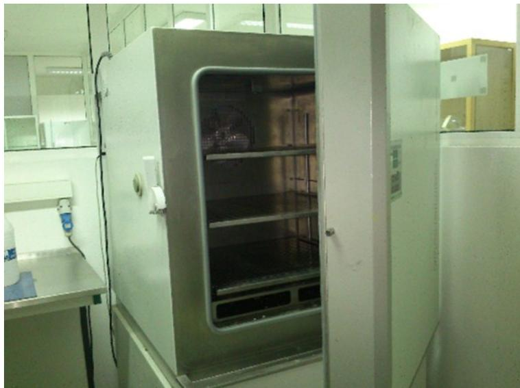
Figura 4-28 – Armazenamento de argamassas na câmara climática
