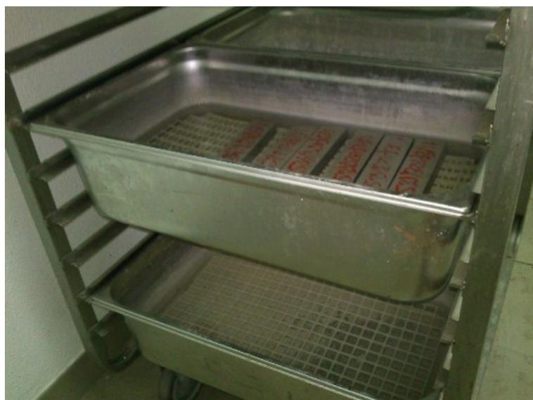
Figura 4-29 – Câmara de cura para armazenamento das argamassas
