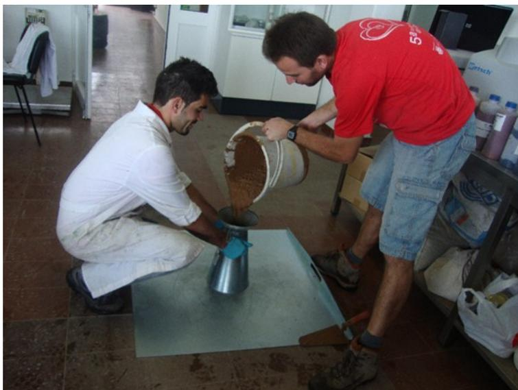
Figura 4-38 – Preenchimento do cone de espalhamento com um BAC
