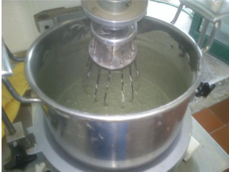
Figura 4-25 – Amassadura de uma argamassa
