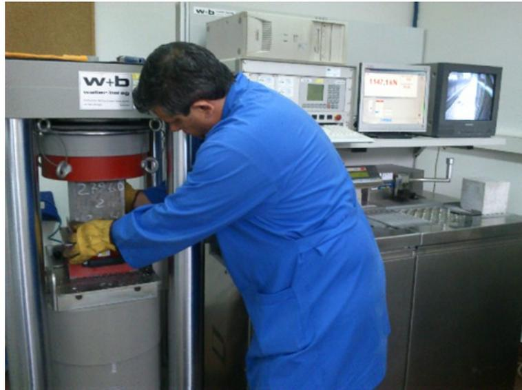
Figura 4-49 – Execução do ensaio de resistência à compressão de um betão
