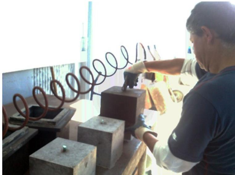
Figura 4-47 – Desmoldagem dos moldes com os provetes de BAC
