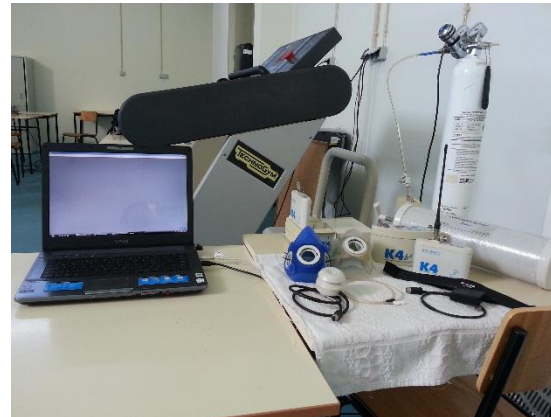
Figura 5- Cosmed K4b 2 (Cosmed, Rome, Italy) com os instrumentos de calibração, os instrumentos de telemetria (PC, antena emissora e recetora), cardiofrequencímetro, mascaras e turbina.
