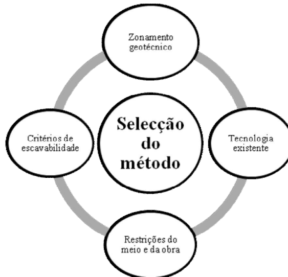
Figura 5.2: Metodologia para selecção do método de escavação.
