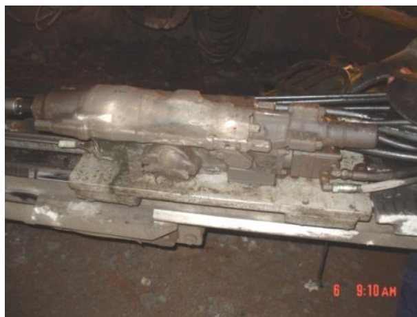
Figura 5.34: Martelo hidráulico de uma perfuradora do jumbo.
