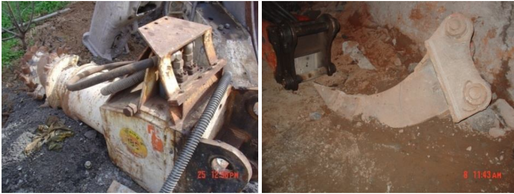
Figura 5.14: Cabeça roçadora à esquerda e um ripper à direita.
