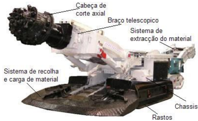
Figura 5.16: Componentes de uma roçadora (adaptado de coalmineservices.com.au).
