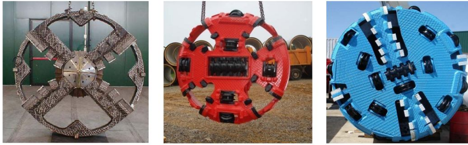
Figura 5.27: Rodas de corte aberta, mista e fechada (adaptado de CARDONA, 2008).
