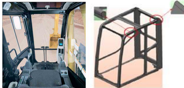
Figura 5.9: Cabine de operação à esquerda e a sua estrutura reforçada à direita (adaptado de komatsu.com).
