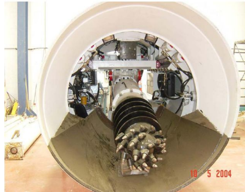
Figura 5.25: Tuneladoras de escudo aberto com roçadora (adaptado de CARDONA, 2008).
