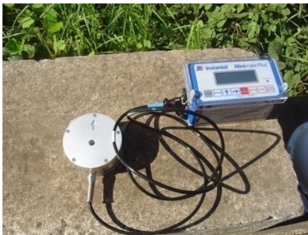
Figura 7.13: Sismógrafo Instanet Minimate Plus.
