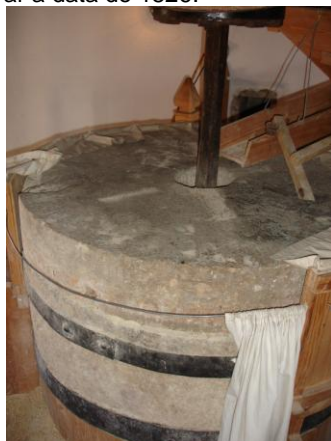
9. Pormenor das duas mós, sendo uma fixa.
