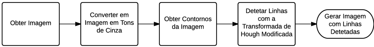
Figura 4.3: Passos usados na detecção de linhas com a Transformada de Hough Modificada.
