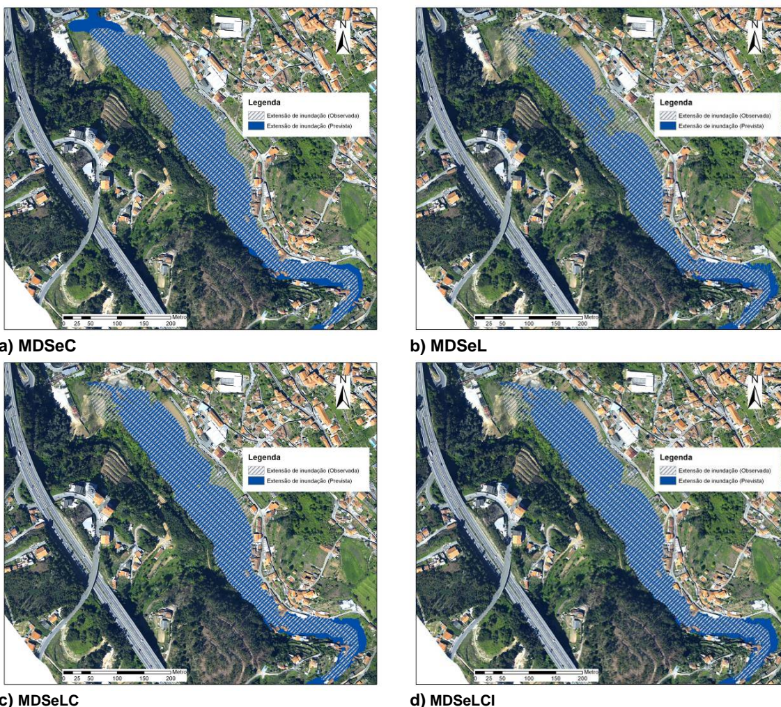
Figura 5.16 - Extensão de inundação prevista pelo modelo e delimitada no trabalho de campo para os vários MDSe.
