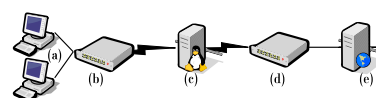
Fig. 1: Esquema simplificado da infraestrutura: (a) Clientes Premium e Outros , (b) Switch A, (c) Gateway , (d) Switch B, (e) Servidor Apache.
