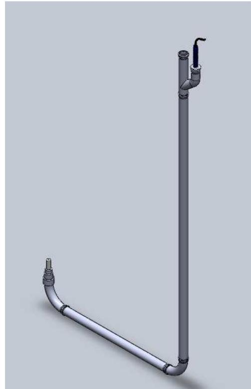
Fig. 1 – Estrutura em PVC de protecção do cabo óptico para medições em profundidade.
