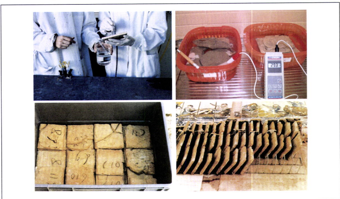
Fig. 5_78 e Fig. 5_79 – Testes e preparação do processo de dessalinização em água desionizada. Fig. 5_80 – Azulejos imersos em água destilada. Para facilitar a operação foi criado um espaçamento entre os azulejos utilizando fragmentos de material refractário. Fig. 5_81 – Após a dessalinização os azulejos devem secar à temperatura ambiente.
