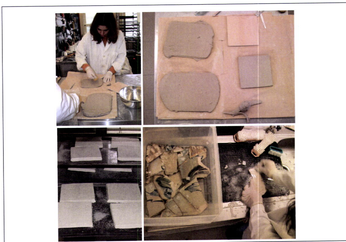
Fig. 5_237 a Fig. 5_239 – Preparação da chacota para a reprodução de azulejos. Fig. 5_240 – Limpeza de fragmentos de azulejo, por via húmida.
