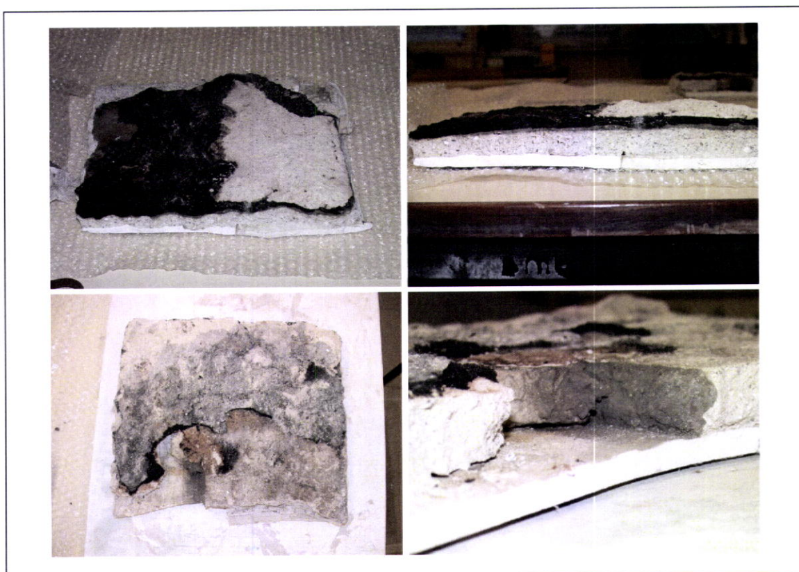
Fig. 5_183 a Fig. 5_186 – Vários pormenores das argamassas existentes agarradas aos azulejos.
