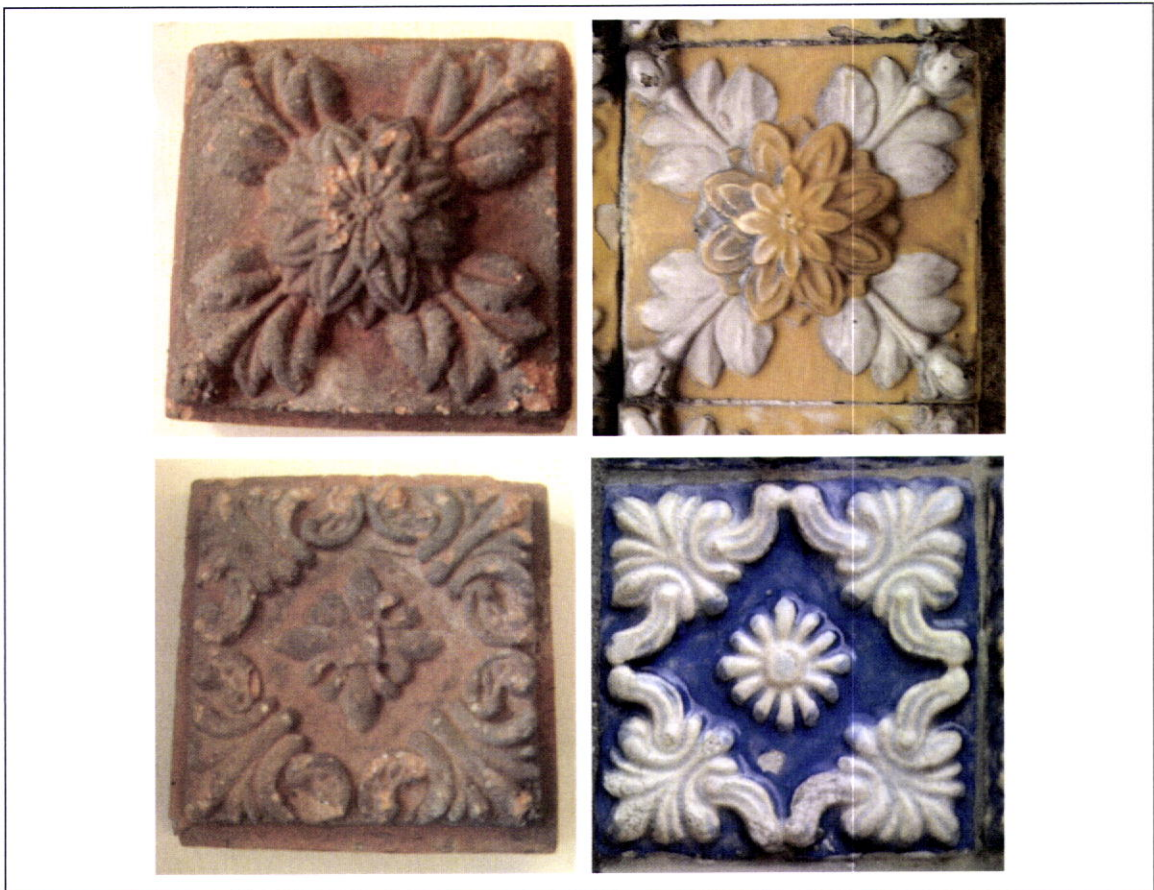
Fig.2_74 – Molde em grés utilizado no fabrico de azulejos em relevo. Molde pertencente ao Banco de Recolha de materiais da cidade do Porto - Casa Tait. Os azulejos que utilizavam esta técnica eram conhecidos como azulejos relevados.
