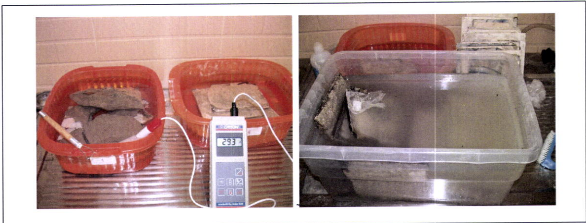
Fig. 5_215 e Fig. 5_216 – Dessalinização dos azulejos em água desionizada, operação controlada.
