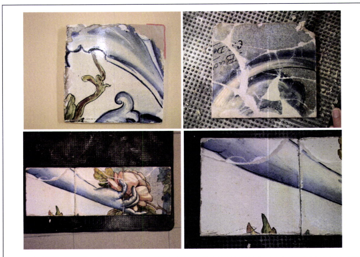
Fig. 5_218 a Fig. 5_221– Alguns pormenores dos azulejos preparados para a integração cromática.
