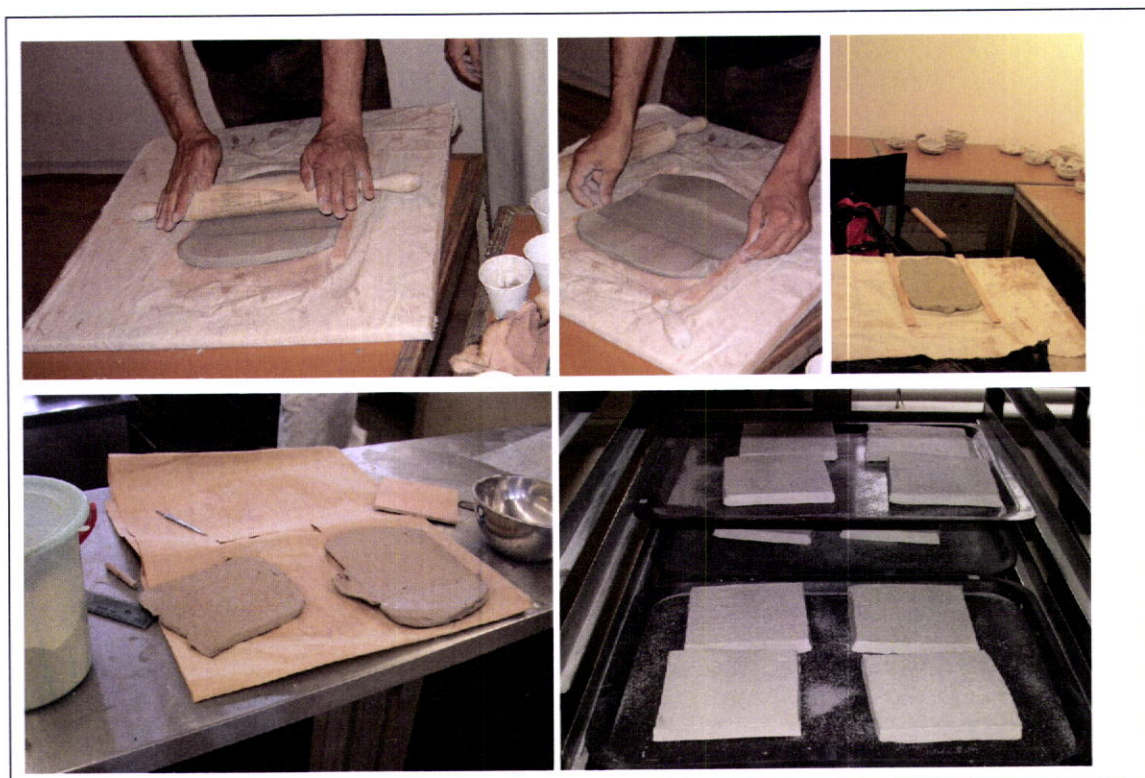
Fig. 5_105, Fig. 5_106 e Fig. 5_107 – Preparação da pasta para fazer a chacota. Técnica de “lastra” com execução manual. Fig. 5_108 e Fig. 5_109 – Preparação da chacota para a primeira cozedura.
