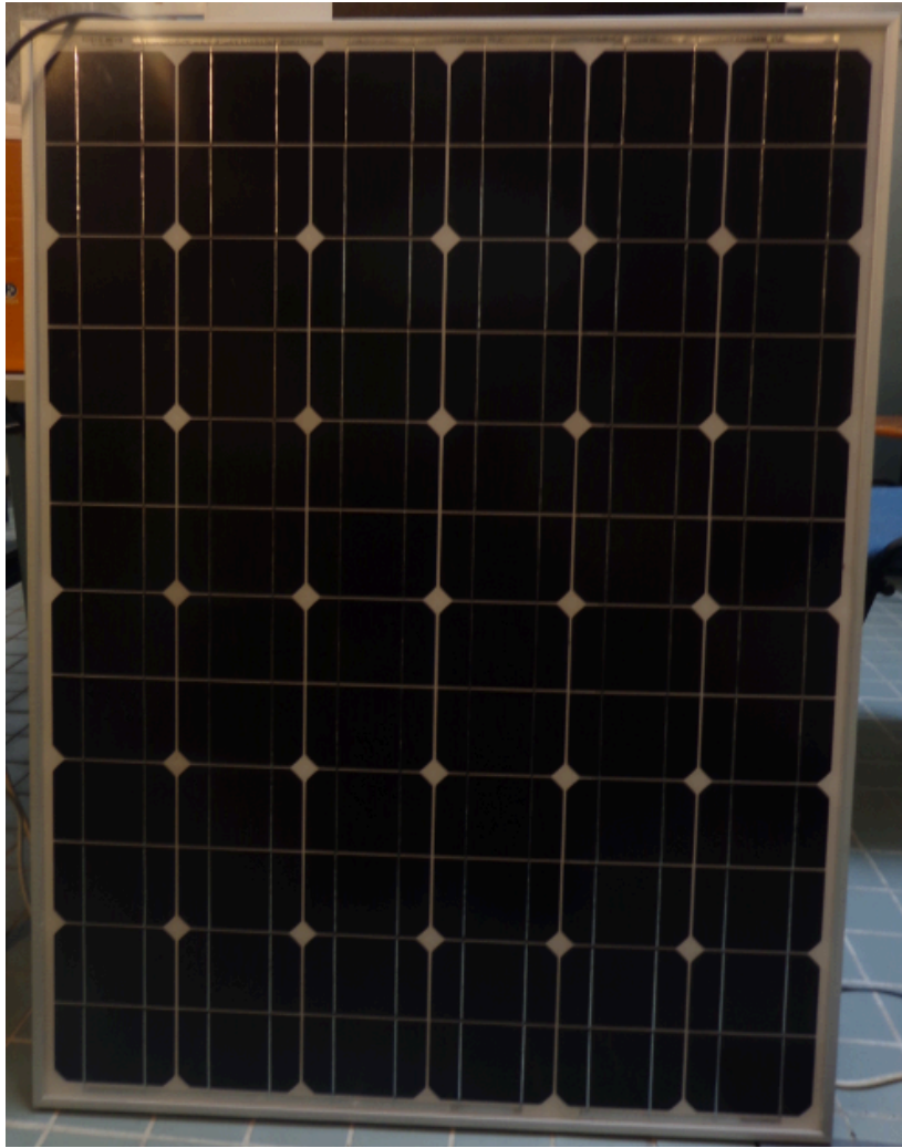
Figura B.2- Painel Solar de 130W. SUOYANG, Modelo SY-130M (utilizado na estação ASER).
