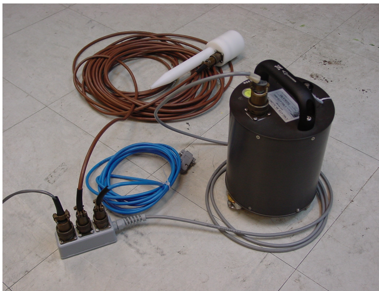
Figura 3.6- Exemplo Sismómetro de banda larga GURALP CMG-6TD, das estações autónomas da rede UE.
