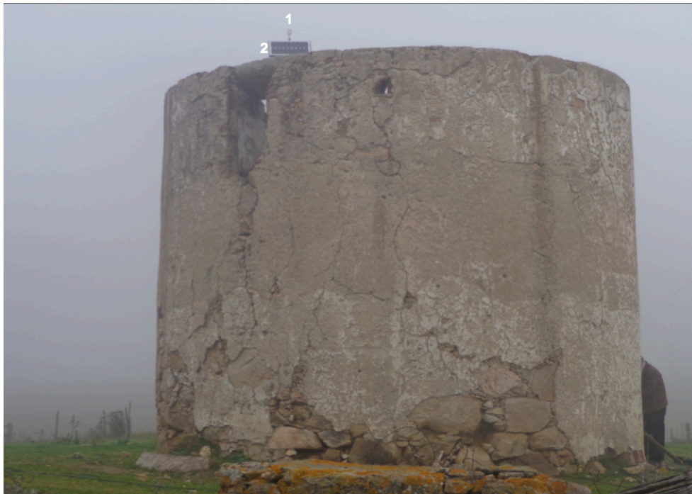
Figura 3.16- Estação sismográfica CARR (Carrascal) localizada nas coordenadas 38°47.8256'N e 07°54.2158'W. Legenda: 1- GPS; 2- Painel Solar de 20 W (SUOYANG SY-20M).
