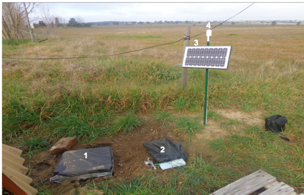
Figura 3.18- Estação sismográfica CABID (Monte do Cabido) localizada nas coordenadas 38'44.3151N e a 07'56.1091W. Legenda: 1- Local de instalação do Sismómetro de Banda larga GURALP CMG 6TD (30s) enterrado sobre afloramento rochoso granítico e protegido por uma manta térmica e por uma caixa isoladora, garantindo bom isolamento térmico e evitado desta forma a flutuações térmicas diárias; 2- Caixa protetora das baterias de 12 V (44 Ah/440 A(EN)), dos cabos e do Breakout box CMG-6TD; 3- Painel Solar de 20 W (SUOYANG SY-20M); 4- GPS.
