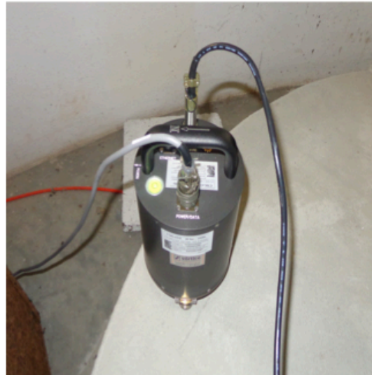
Figura 3.12- Sismómetro Guralp CMG-6TD assente em um pilar de cimento consolidado.
