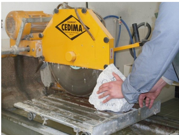
Fig. 54 - Serra elétrica para corte da amostra inicial.
