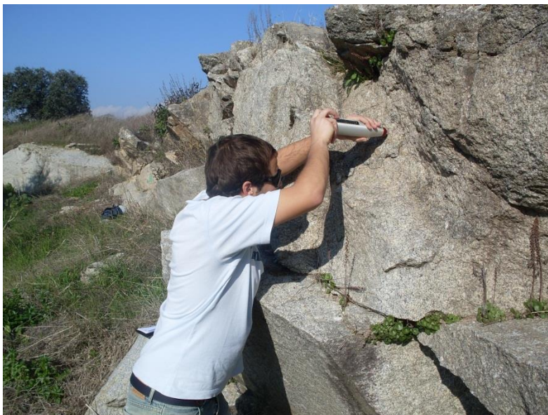
Fig. 70 - Realização do ensaio com o martelo de Schmidt.
