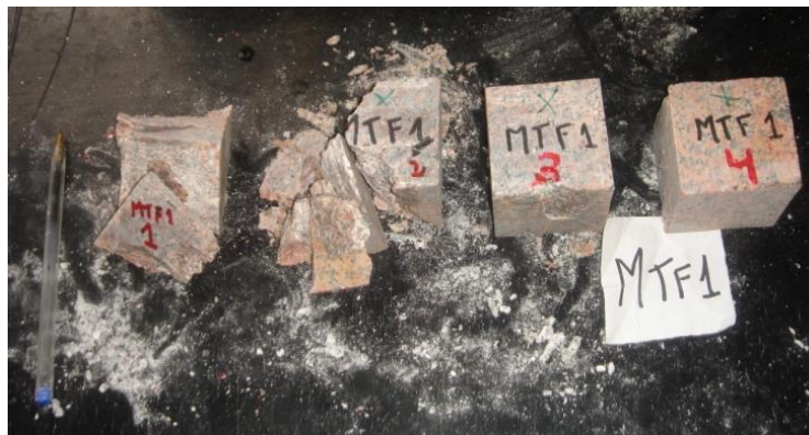
Fig. 74 - Provetes da amostra MTF-1 após ensaio.
