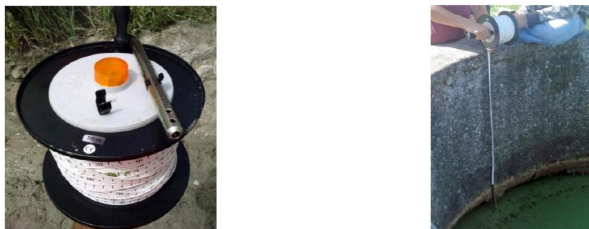
Fig. 51 - Sonda de nível SEBA Hydrometrie.
