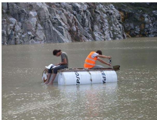
Fig. 49 - Medição da coluna de água nas lagoas da “Pedreira do Monte das Flores”.
