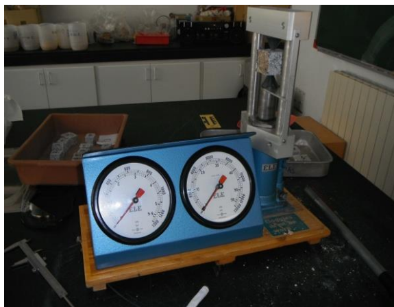
Fig. 68 - Equipamento utilizado, no ensaio de carga pontual.
