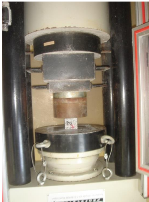
Fig. 67 - Realização do ensaio de compressão uniaxial.
