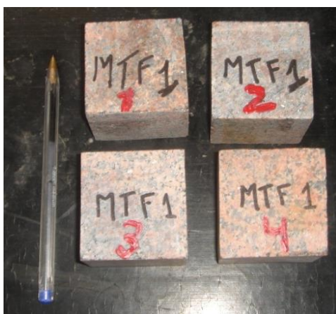
Fig. 73 - Provetes da amostra MTF-1 antes do ensaio.
