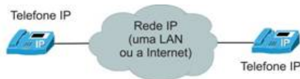
Figura 2.3: Ligação VoIP entre telefones IP [2]
