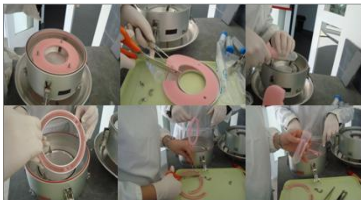
Figura 9: Substituição dos Filtros XL e M do colector de impacto CHEMVOL-Sampler.
