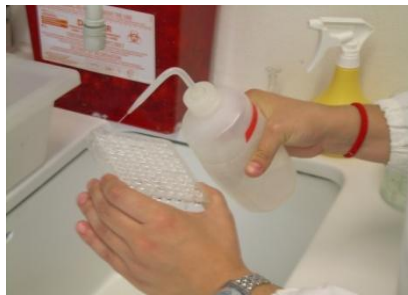
Figura 11: Lavagem das microplacas.
