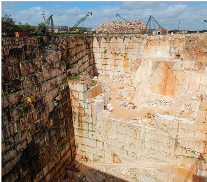
Fig. 1 - Pedreira em atividade, Encostinha - Borba. Atualmente com 85 metros de profundidade, está abaixo do nível freático o que obriga a uma constante bombagem de água para que as operações de extração de mármore possam decorrer ao longo de todo o ano. Nos socalcos entre pisos observa-se o início da colonização por plantas. Em pedreiras abandonadas há dezenas de anos constata-se uma recuperação natural acentuada e uma ocupação por um número de espécies superior ao encontrado em ecossistemas próximos não intervencionados pelo Homem [Germano, 2013].
