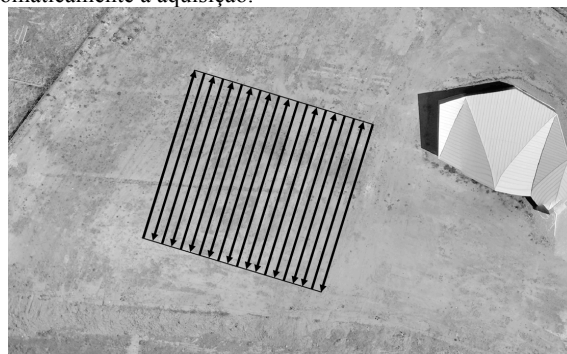
Figura 2 – Configuração em zig-zag adoptada para a aquisição dos perfis individuais (zigzag configuration adopted for the acquisition of individual profiles).
