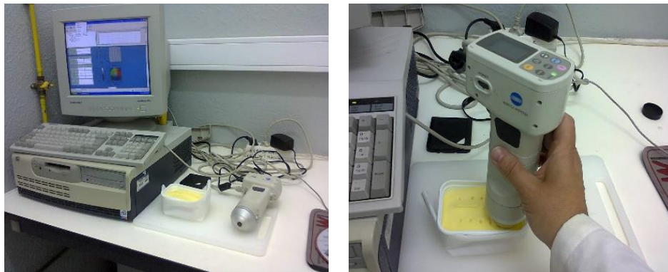
Figura 4.6: Aspecto geral do colorímetro de reflectância CR-400. É possível observar no monitor do computador o diagrama do espaço de cor CIELab.
