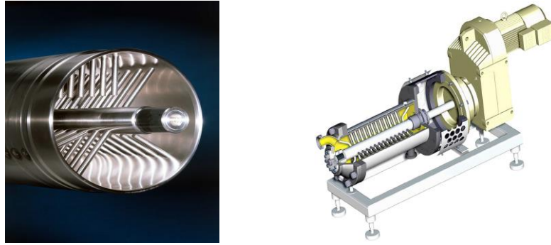
Figura 2.8: Fotografia e representação esquemática de permutadores SSHE.
