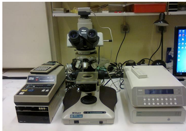
Figura 4.3: Aspecto geral do microscópio Nikon Optiphot-2-Pol com câmara digital Moticam 2000 utilizado neste trabalho.
