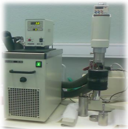
Figura 4.2: Aspecto geral do viscosímetro Thermo Haake VT-550, cup , sensor MV1, e banho K10.
