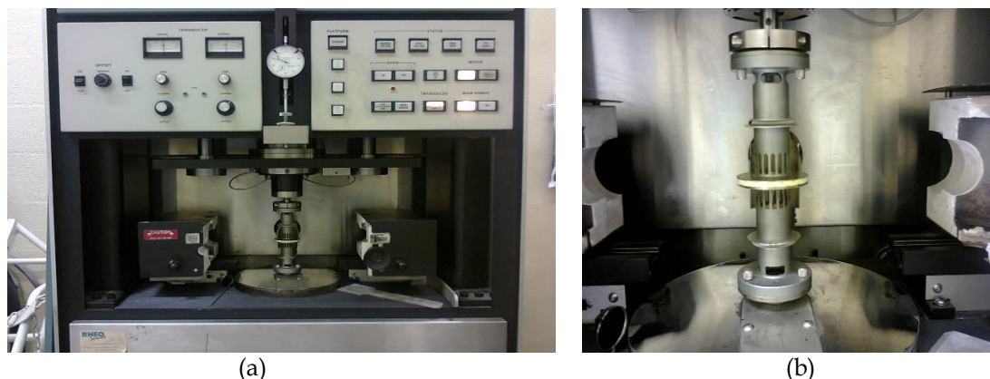
Figura 4.1: (a) Aspecto geral do espectrómetro mecânico Rheometrics RMS-800 utilizado nos ensaios reológicos; (b) pormenor da execução de um ensaio com a geometria de pratos paralelos rugosos com 50 mm de diâmetro.
