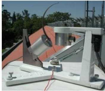
Figura 6 - Radiómetro espectral YES MFR-7. [26]
