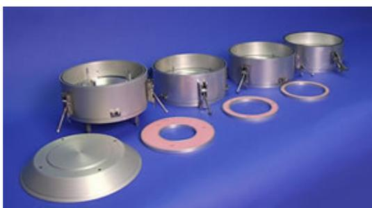
**Figura 8.** CHEMVOL-Sampler e os vários tamanhos de filtros (adaptado de <http://www.bgiusa.com>)
