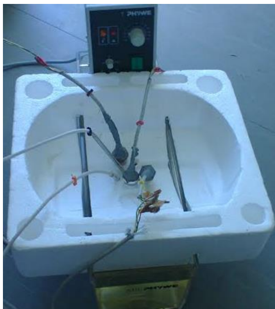
Figura 22 - Sondas de temperatura aquando do processo de recolha de dados para calibração.
