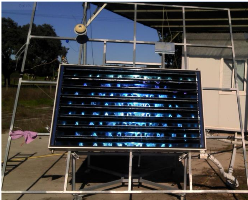
Figura 28 - Coletor solar térmico do tipo CPC em ensaio.
