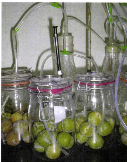
Fig.10 - Contentores ventilados com frutos
